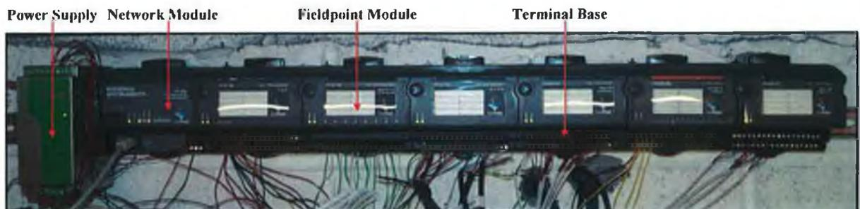
**FIGURE 3.27** *HP-IRL* DATA ACQUISITION SYSTEM.
