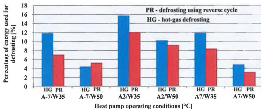
**FIGURE 2.18** PERCENTAGE OF TOTAL HEAT PUMP ENERGY CONSUMPTION THAT IS PARASITIC FOR DEFROSTING PURPOSES (ZOGG, 2003).
