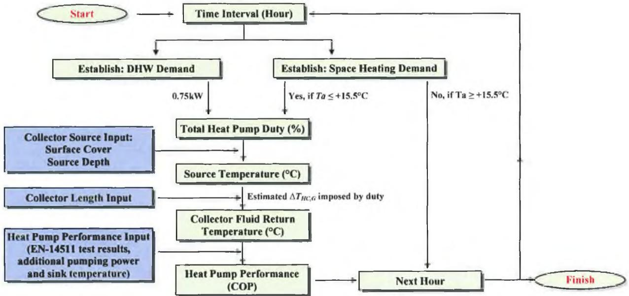
FIGURE 5.7 HEAT PUMP PERFORMANCE SIMULATION FLOW DIAGRAM
