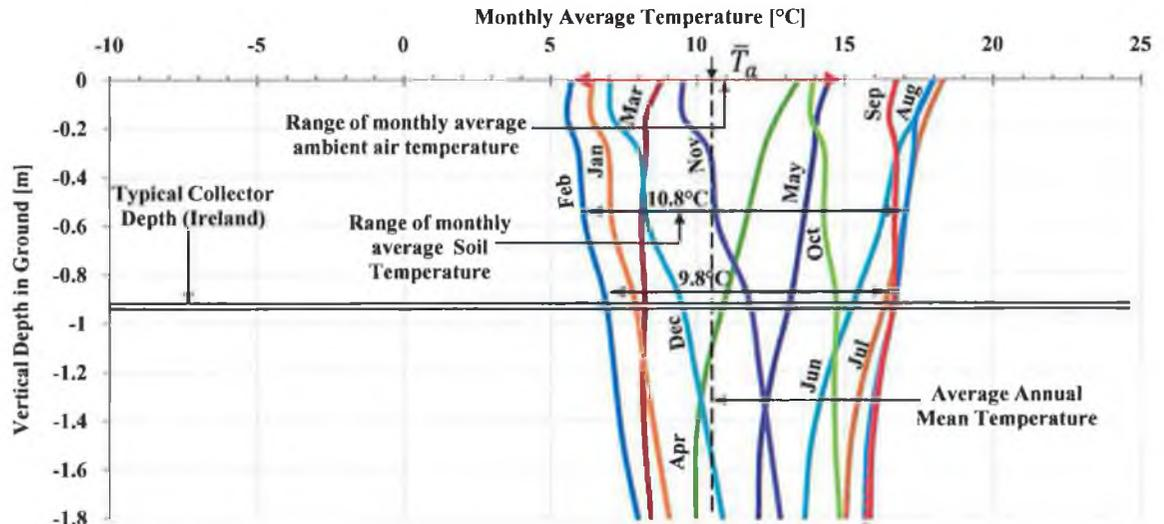
**FIGURE 4.4** MONTHLY AVERAGED GROUND TEMPERATURES RECORDED OVER ONE YEAR IN GALWAY, LATITUDE 53°N (P1, 2007).
