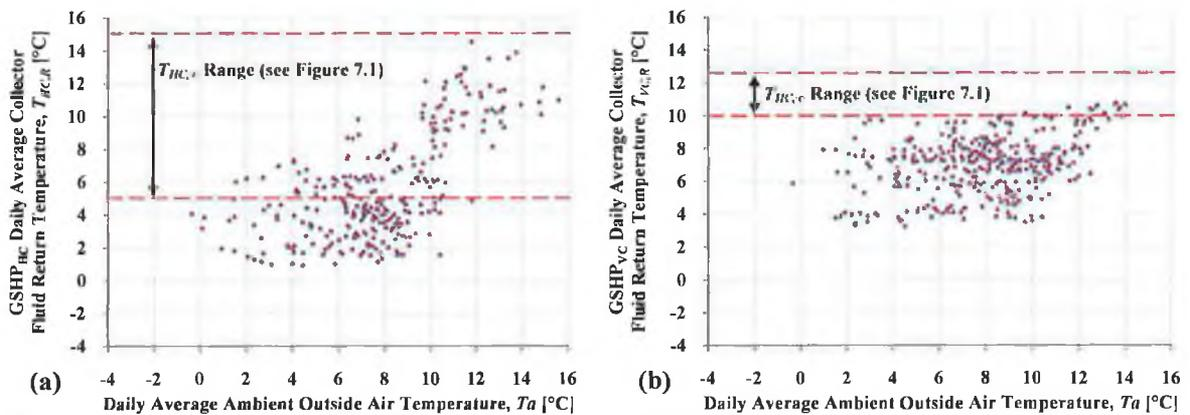
**FIGURE 7.4** DAILY AVERAGED COLLECTOR FLUID RETURN TEMPERATURE AS A FUNCTION OF AMBIENT AIR TEMPERATURE FOR *HP-IRL* (A) GSHP<sub>HC</sub> AND (B) GSHP<sub>VC</sub> OPERATION FROM 2007-2009.
