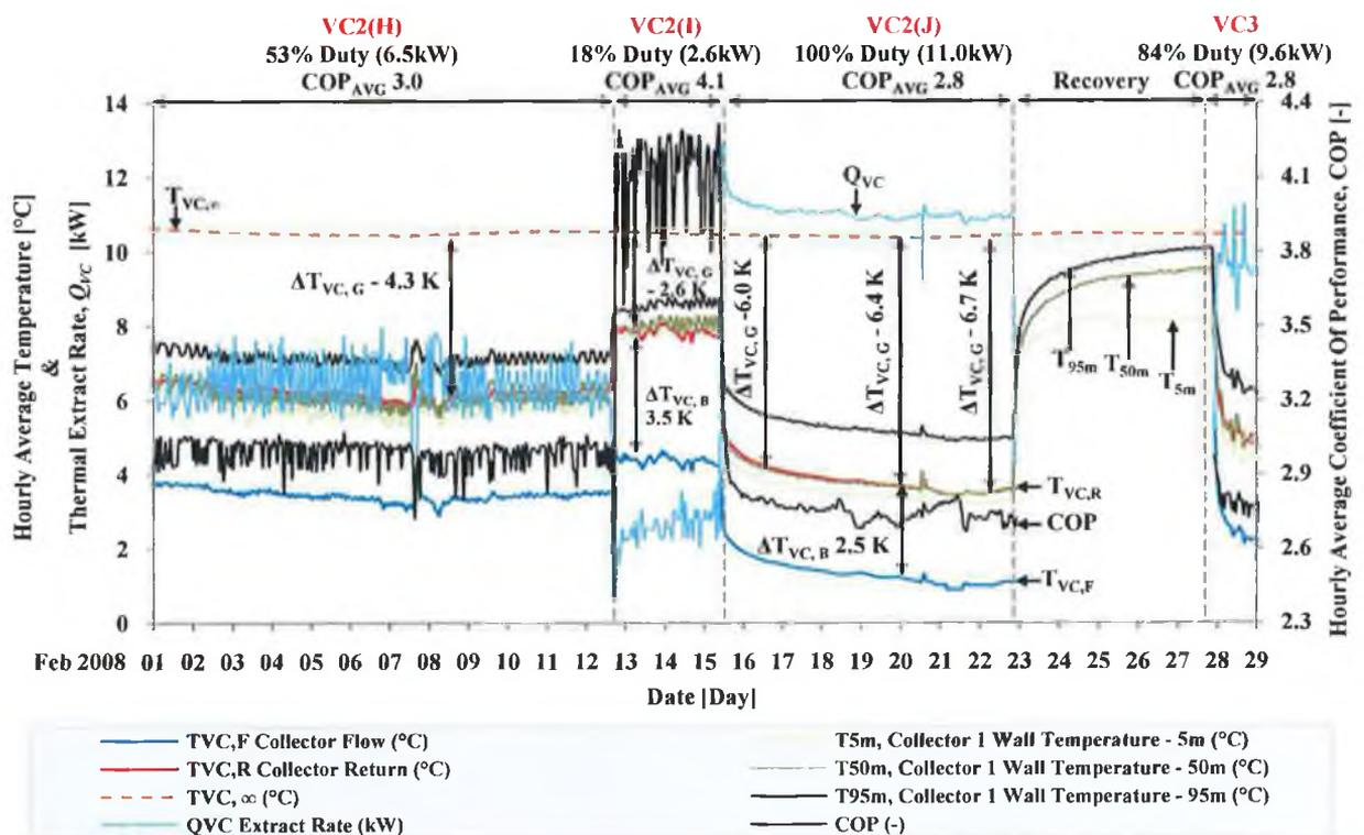
**FIGURE 6.17** THERMAL DRAWDOWN AND RECOVERY OF THE GROUND SURROUNDING THE GSHP<sub>VC</sub> VERSUS HEAT PUMP PERFORMANCE DURING VC 2 AND VC3.
