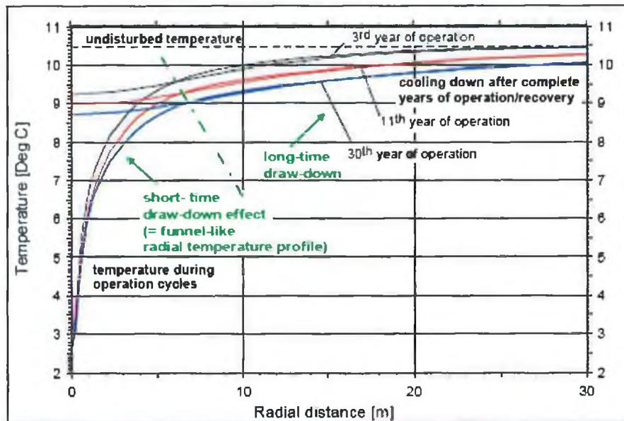
**FIGURE 2.12** POTENTIAL TEMPERATURE DRAWDOWN AT VARIOUS RADIAL DISTANCES FROM THE VERTICAL COLLECTOR OVER THIRTY YEARS OF OPERATION IN SWITZERLAND (EUGSTER AND RYBACH, 2000).
