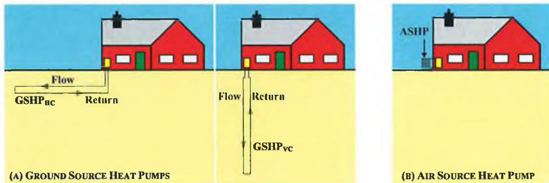
FIGURE 1.1 TYPICAL HEAT PUMP COLLECTOR CONFIGURATIONS.
