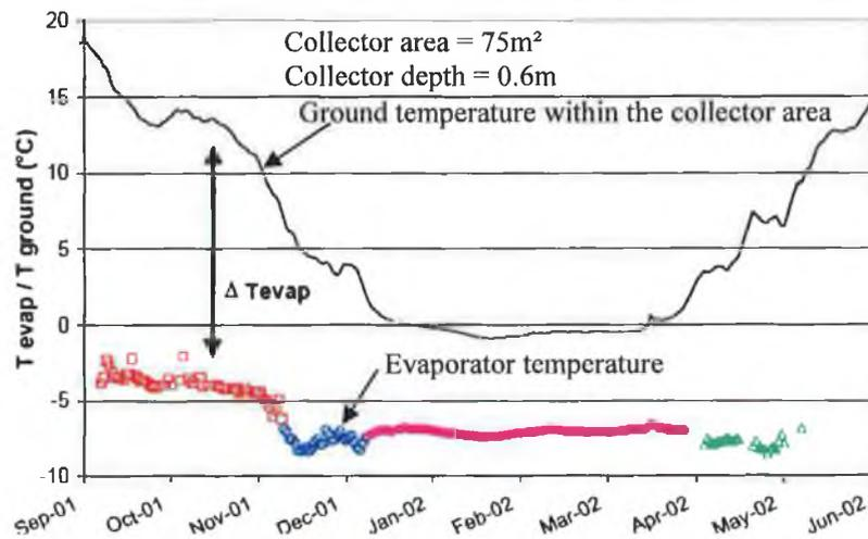
**FIGURE 2.4** HEAT PUMP EVAPORATOR AND THE GROUND TEMPERATURE WITHIN THE HORIZONTAL COLLECTOR (DUMONT AND FRÈRE, 2005).
