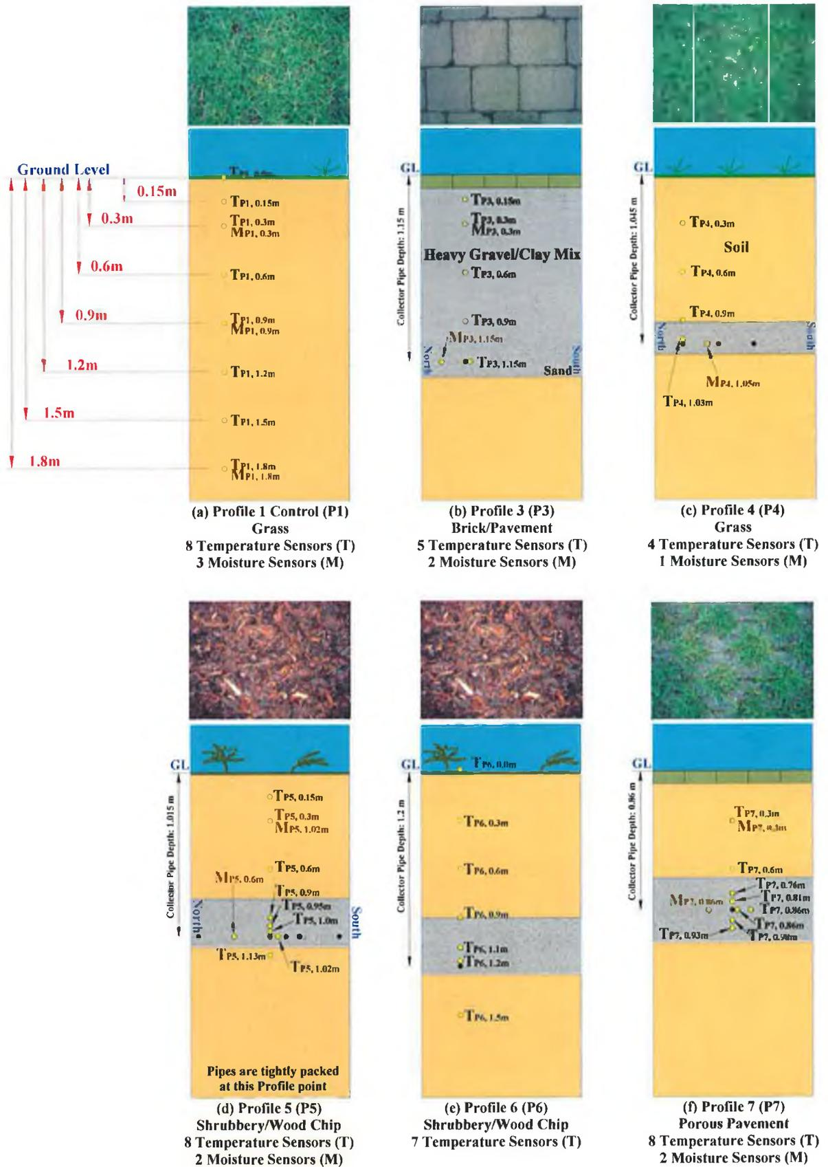
FIGURE 3.20 HORIZONTAL COLLECTOR GROUND PROFILES (LOHAN ET AL., 2006).
