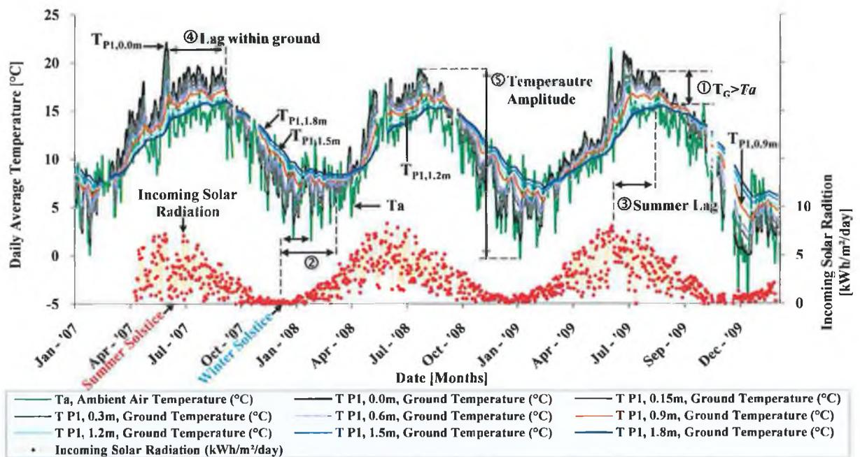
FIGURE 4.1 INFLUENCE OF CLIMATE (SOLAR RADIATION AND AMBIENT AIR TEMPERATURE SHOWN) ON GROUND TEMPERATURE.
