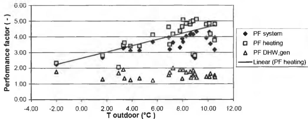
**FIGURE 2.17** ASHP PERFORMANCE DATA AS A FUNCTION OF EXTERNAL AMBIENT AIR TEMPERATURE IN 2006/2007 (VERHELST *ET AL.*, 2008).
