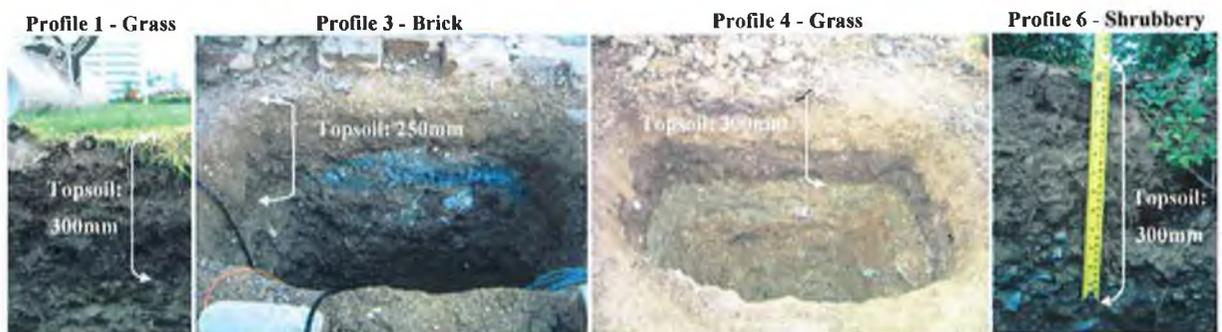
FIGURE 3.19 HORIZONTAL COLLECTOR GROUND COMPOSITION.
