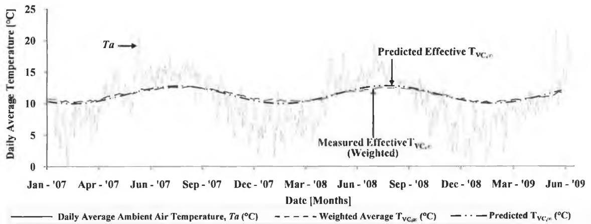
**FIGURE 6.6** ESTIMATING HP-IRL VERTICAL COLLECTOR EFFECTIVE FARFIELD TEMPERATURE.
