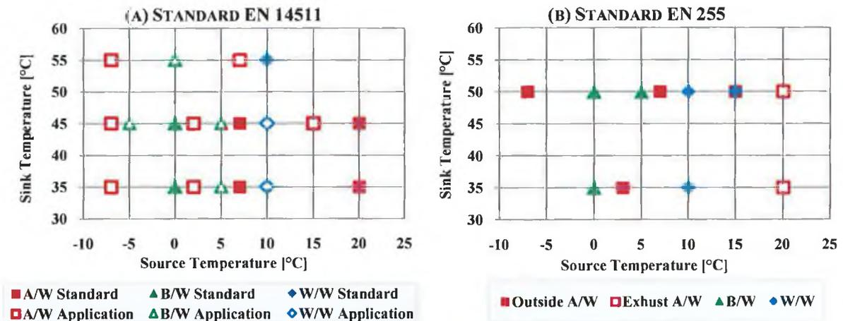
FIGURE C.1 STANDARD TEMPERATURES FOR HEAT PUMP PERFORMANCE ANALYSIS.
