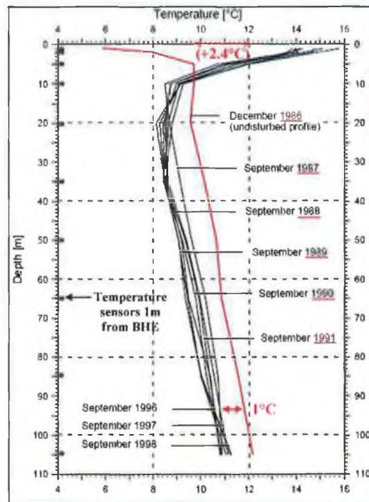
**FIGURE 2.11** TEMPERATURE DRAWDOWN OF A VERTICAL COLLECTOR MONITORED OVER A FIVE YEARS OPERATION IN SWITZERLAND (EUGSTER AND RYBACH, 2000).
