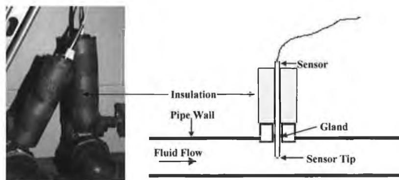
**FIGURE 3.15** TEMPERATURE SENSOR *IN SITU*.
