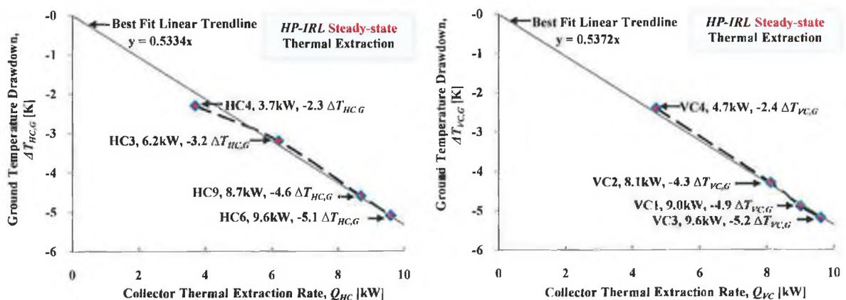
**FIGURE 7.6** STEADY-STATE GROUND TEMPERATURE DRAWDOWN VERSUS THERMAL EXTRACTION RATE FOR THE (A) HORIZONTAL COLLECTOR AND (B) VERTICAL COLLECTOR.
